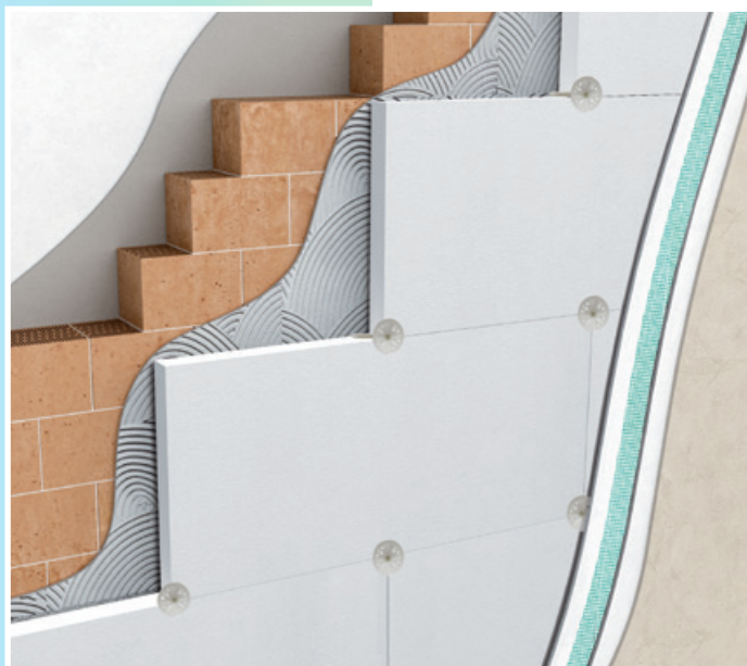
Isolamento a cappotto su parete in laterizio
