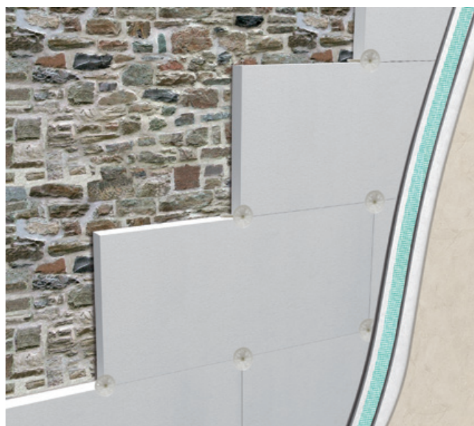
Isolamento a cappotto su parete in pietra
