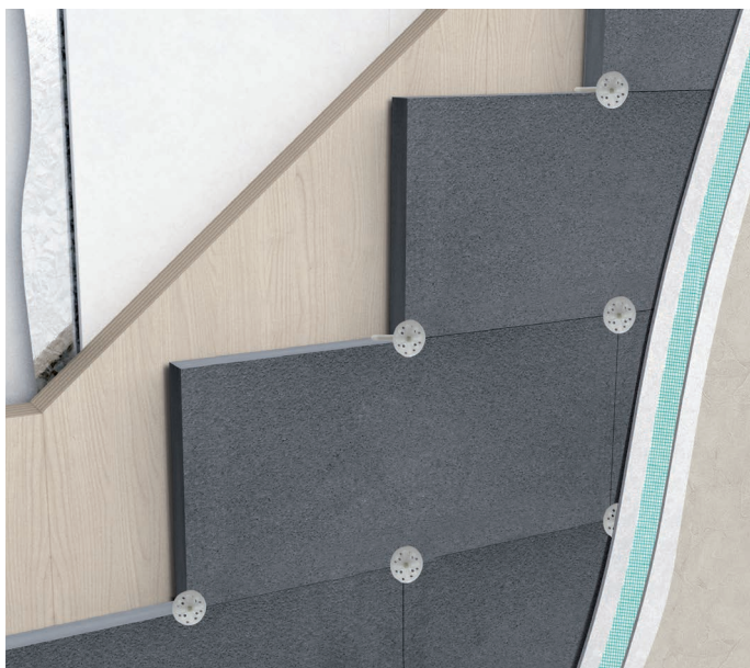
Isolamento a cappotto su parete in legno
