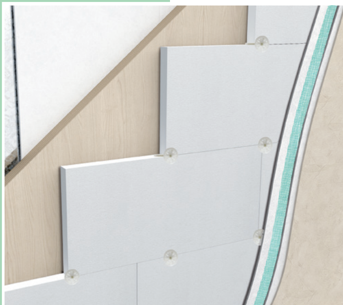
Isolamento a cappotto su parete in legno
