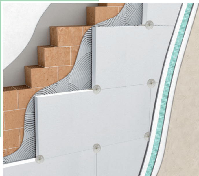
Isolamento a cappotto su parete in laterizio
