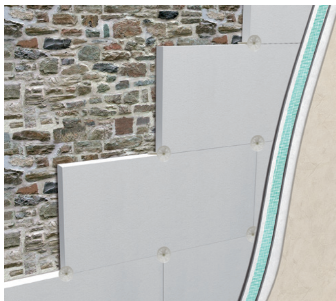
Isolamento a cappotto su parete in pietra
