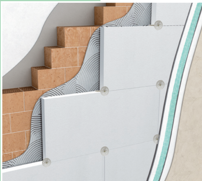
Isolamento a cappotto su parete in laterizio
