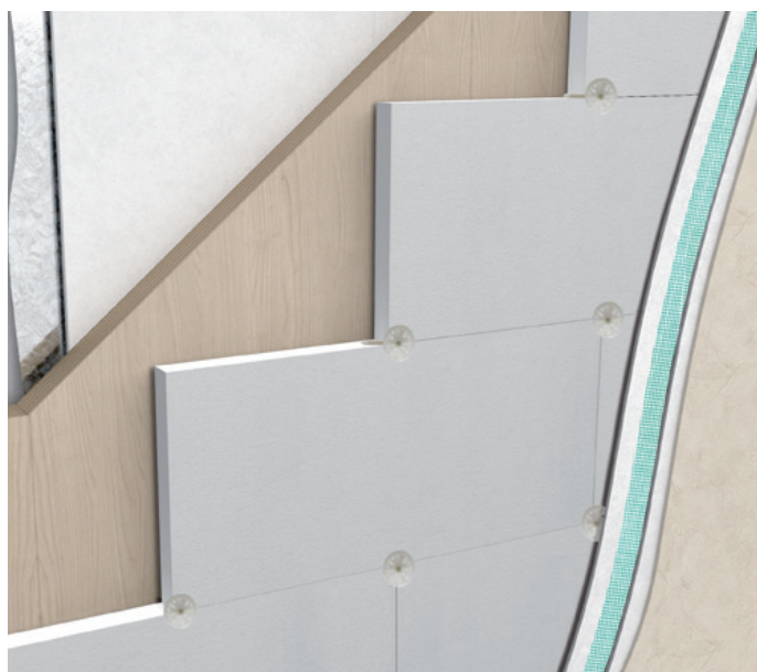
Isolamento a cappotto su parete in legno
