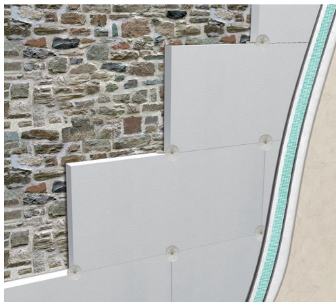
Isolamento a cappotto su parete in pietra
