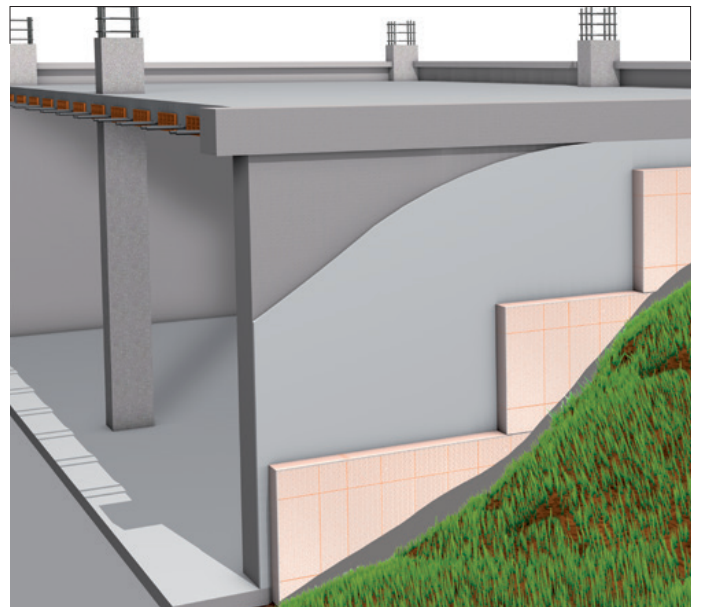
Isolamento del perimetro e del sistema fondazionale
